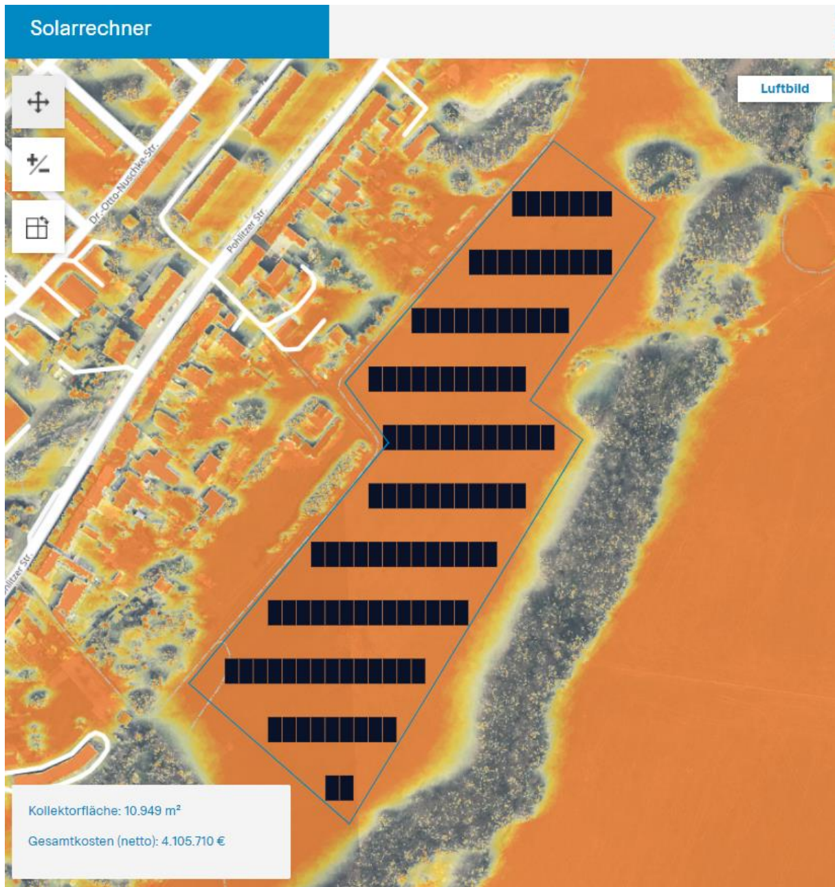
Abbildung 33: Screenshot Solarthermieanlage mit ca. 11.000 m 2 Bruttokollektorfläche
